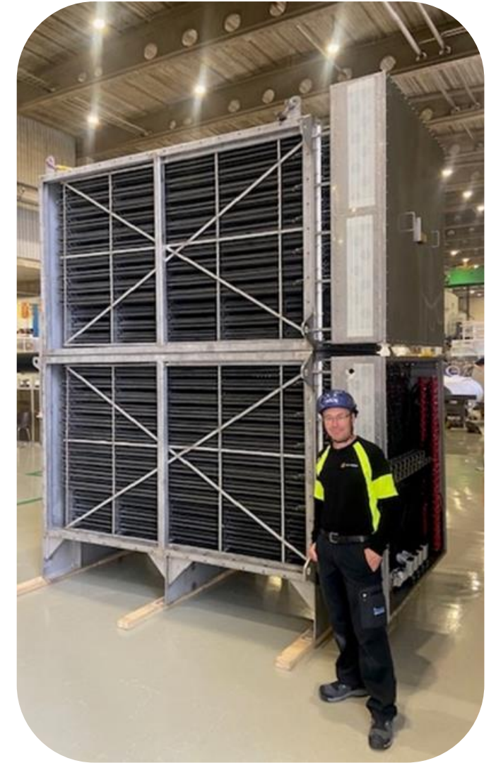
Kuvassa 6 MW sähköinen kanavalämmitin leijukuivaimelle
